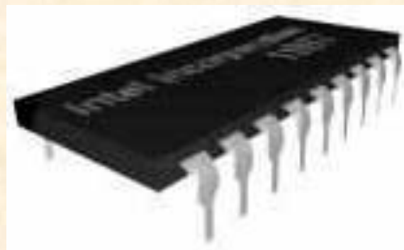
Коробка с контактами (ИС – внутри)
